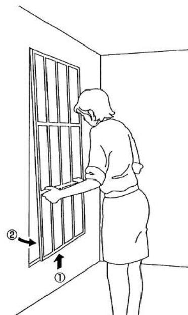
敷居の障子をはずすときと同じように、障子の横棧を両手で持ち上げます。上部かまち(枠)が鴨居の溝に深く入り、下部かまちが浮いてはずれます。
