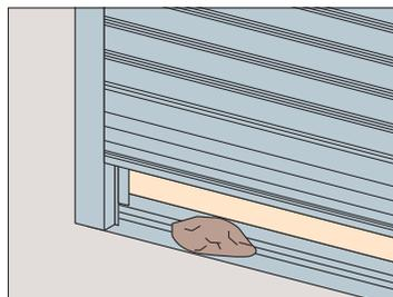
下降時に障害物感知システムが作動すると、シャッターは自動的に反転上昇し、上限位置から約10cmの位置で停止します。リモコンの「ひらく」ボタンを押してシャッターを全開にしたあと、障害物を取り除いてください
